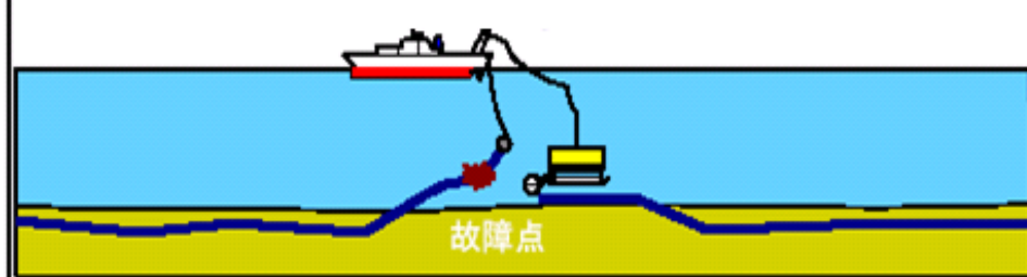
③ ROVによるリフトラインの取付け・ケーブル回収
