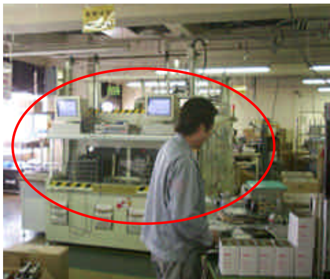
前工程 :衝撃試験 / 機能試験 / 通信試験
