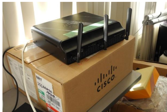
Cisco Systems社 3G対応ルーター Cisco 1941 300Kbps ~ 2.5Mbps (NTT DoCoMo FOMA サービス状況に依存)
