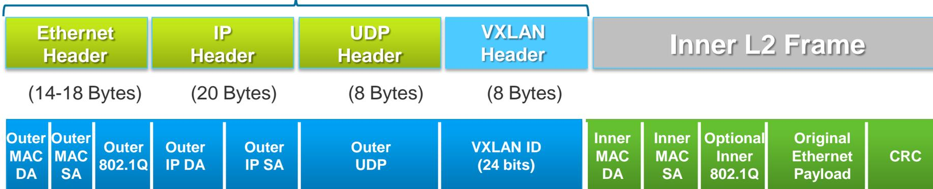
← VXLAN Encapsulation → ← 元の Ethernet フレーム →
