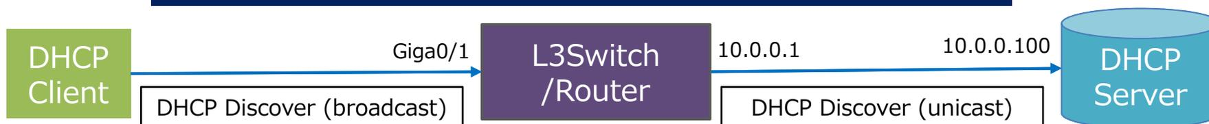
broadcastはL3を超えられないが、relay-agentによりunicast変換されてDHCPサーバまで届く
