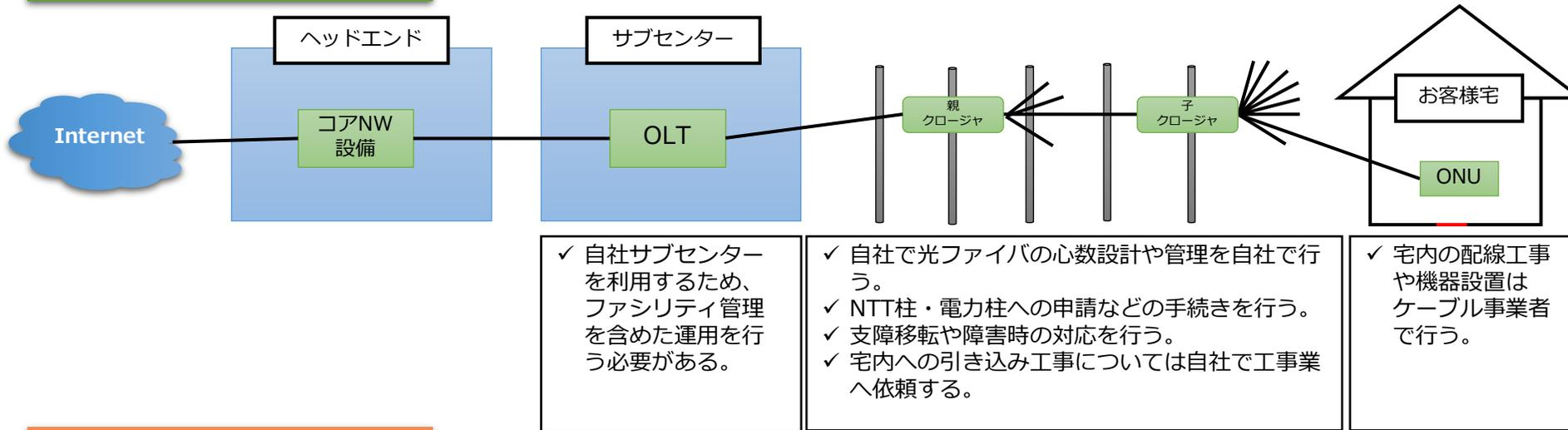
➤ シェアドアクセス方式とは、NTTのビルをサブセンターの代わりとして活用するとともに、**伝送路と引き込み線を借用して行う光化**
