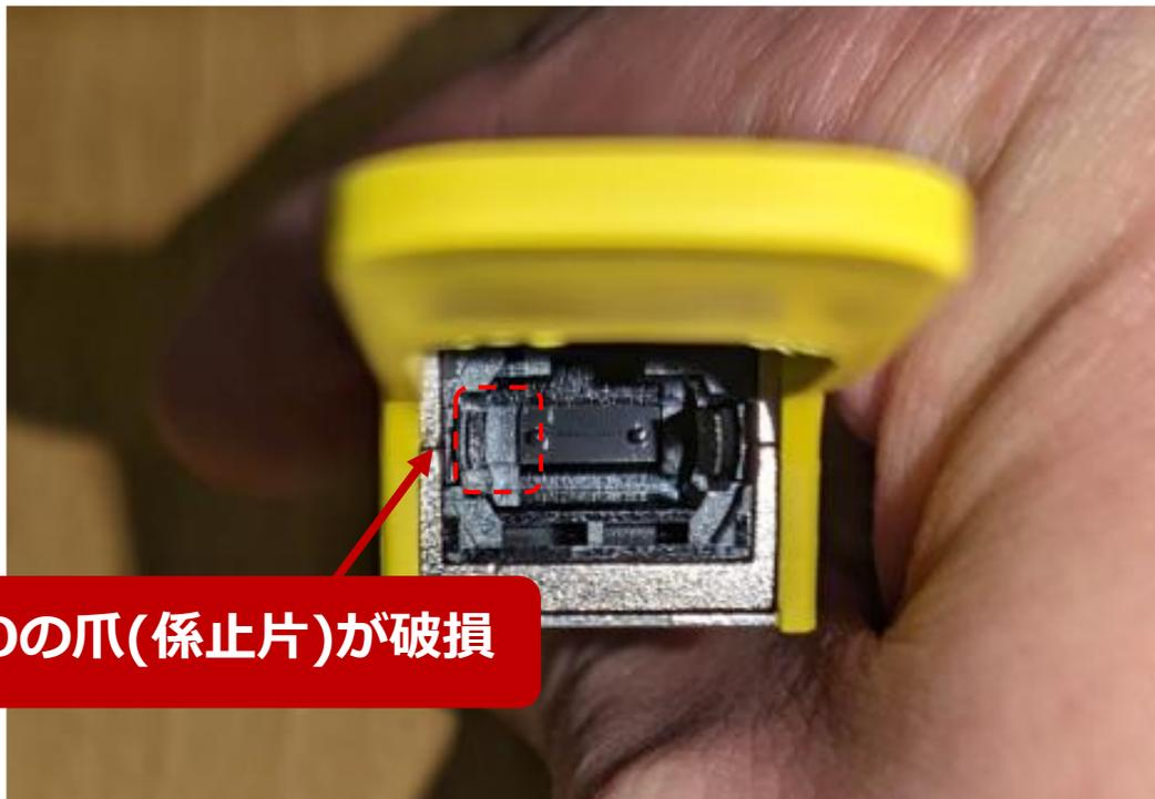
**MPOの爪(係止片)が破損**
