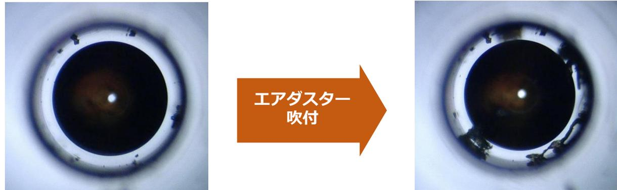
ピンホールとペンタイプクリーナ先端が接触した際に**塵埃の発生を確認**。
