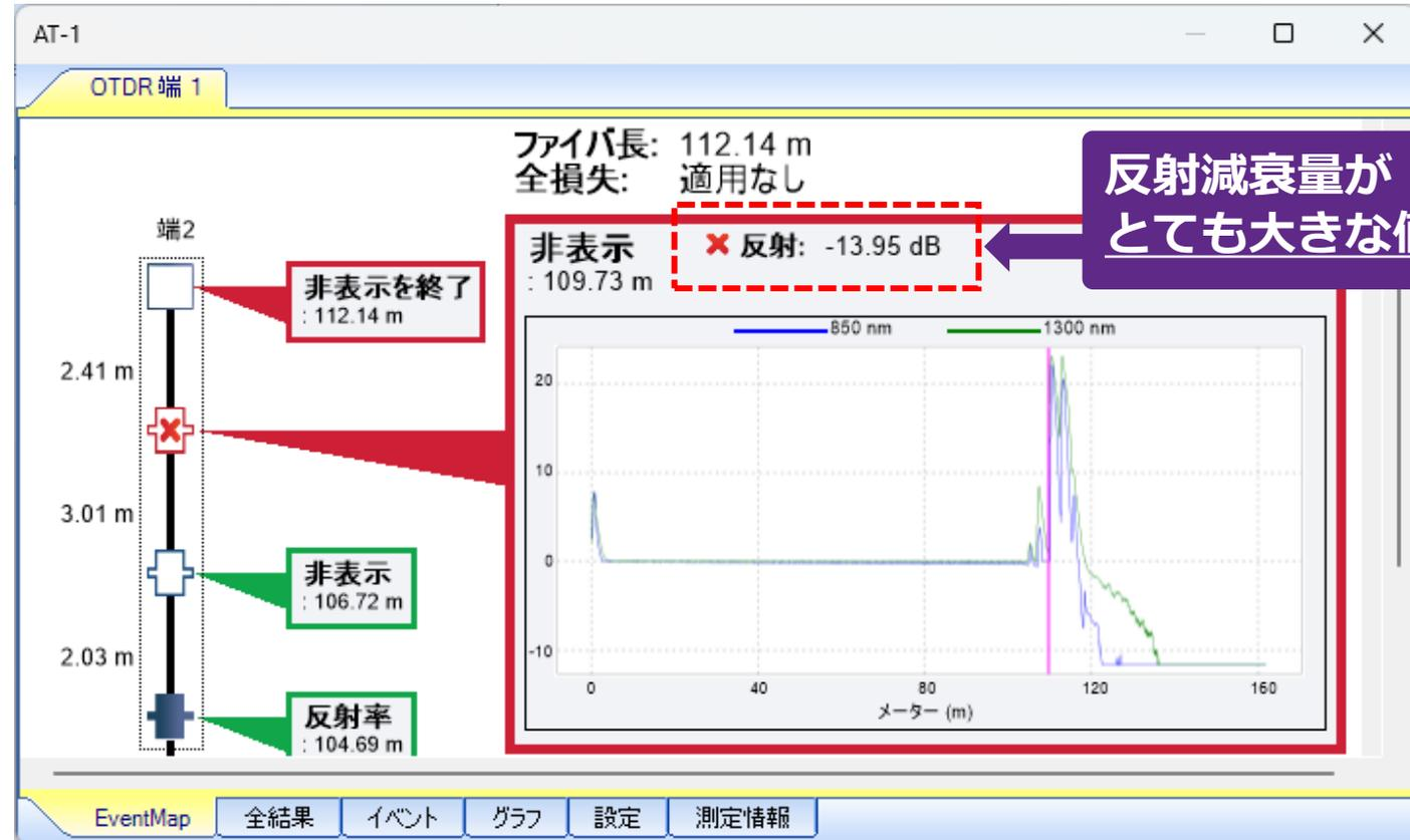
空気層の反射(フレネル反射)よりも大きい値となっており、ファイバ同士が正常に接続されていない状態。
