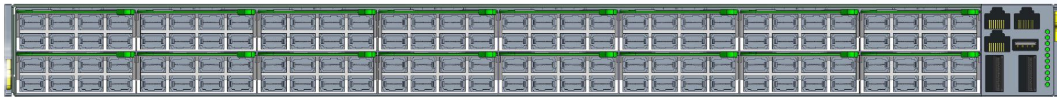
16個のXPOモジュールを搭載した204.8Tスイッチは1UのOCPラックに収容可能
